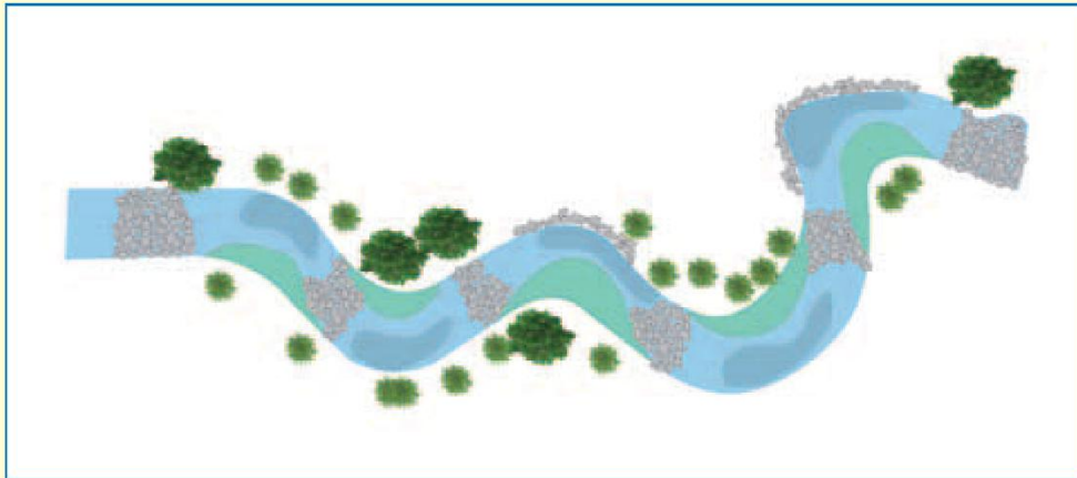
Figura 1.6 – Sezione e andamento planimetrico tipici di un canale di tipo naturalistico scavato ex-novo. Il profilo trasversale dell'alveo a più stadi (in alto) degrada dolcemente passando dal piano campagna all'alveo di magra, ospita vegetazione acquatica ed arboreo-arbustiva e può essere soggetto a evoluzione morfologica nel corso del tempo; l'andamento planimetrico (in basso) è sinuoso e l'alveo è morfologicamente diversificato grazie alla presenza di buche, raschi, depositi di sedimenti, ecc.
